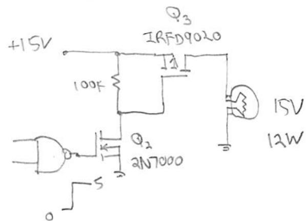
(b) NAND output = 0V << 3V  $\leftarrow$  Q<sub>2</sub> OFF ✓= 5V >> 3V  $\leftarrow$  Q<sub>2</sub> ON ✓
